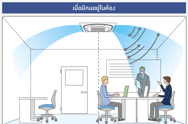
กระจายลมให้เหมาะสมกับอุณหภูมิห้องอัตโนมัติ
